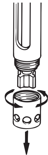
図12. ヘッド/スクリーンの交換 - チューブラーアセンブリ
